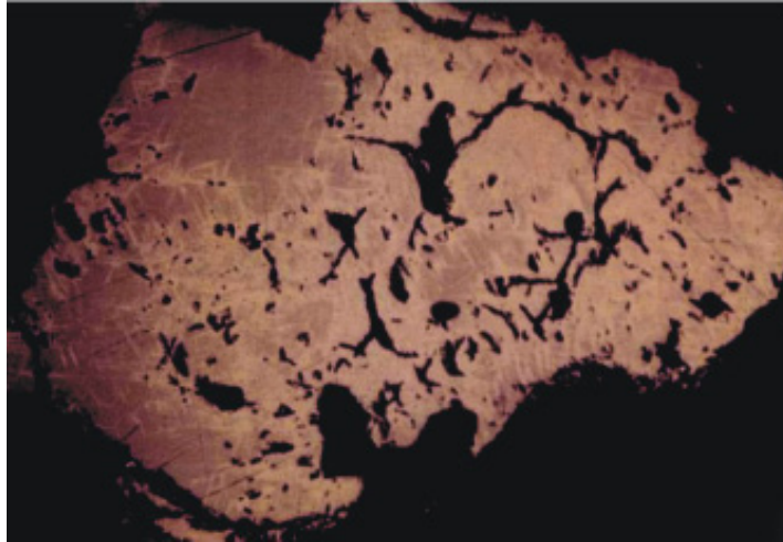
Figura 2. Grano de titanomagnetita perteneciente a la Ig. Guacha (sitio V). Se observan lamellae de ilmenita ss (más claras), concentradas a lo largo de fracturas, inclusiones silicáticas y en los bordes de los cristales. Luz reflejada, en aceite.
