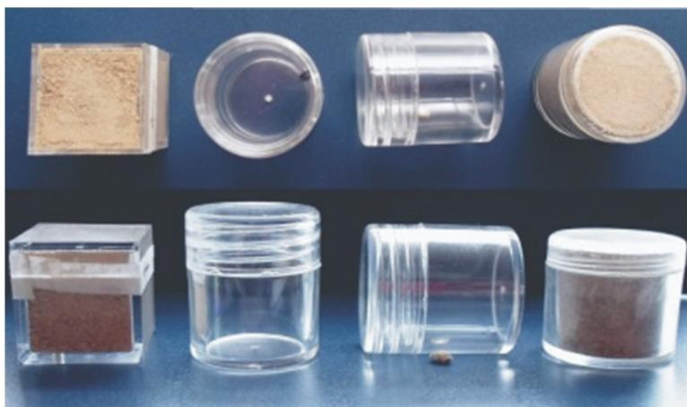
**Figura 1.** Portamuestras de cúbico (ASC Scientific) y cilíndrico (mercado local).
