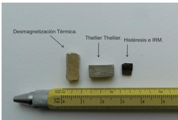
**Figura 1.** Muestras de cerámicas utilizadas en este trabajo.
