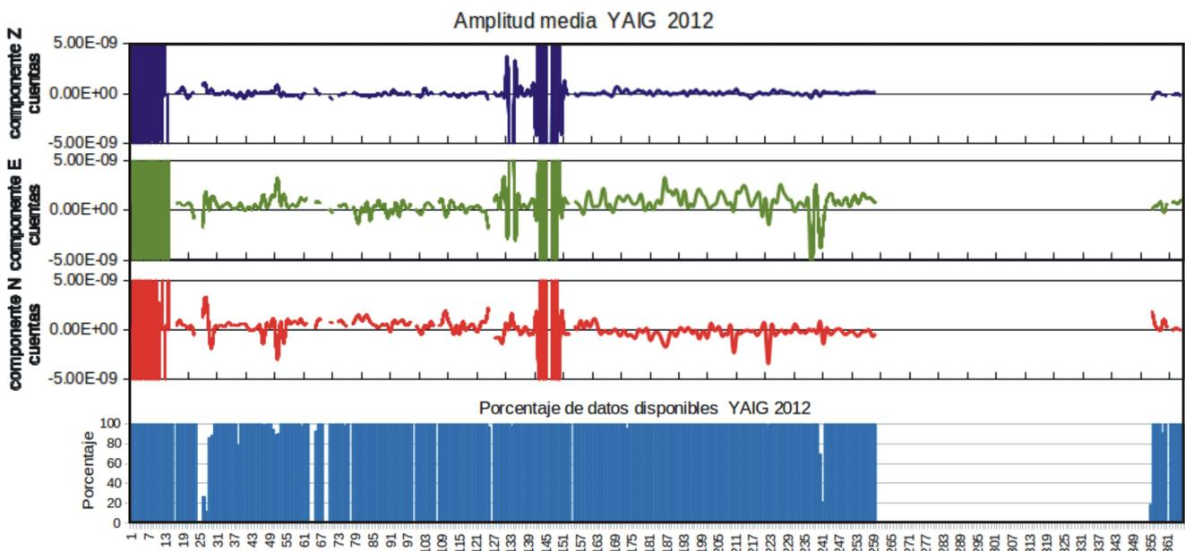
Fig. 4.48. Gráfica de los valores de amplitudes promedio de los registros en continuo de las tres componentes de velocidad de la estación Yautepec y de los porcentajes de disponibilidad de datos en continuo de registros de velocidad. Las valores de las amplitudes promedio están en cuentas. El eje de las abscisas corresponde a los 366 días julianos del año 2012.
