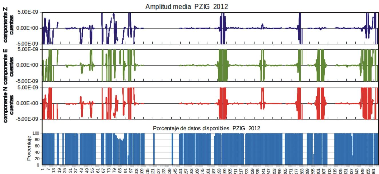
Fig. 4.33. Gráfica de los valores de amplitudes promedio de los registros en continuo de las tres componentes de velocidad de la estación Pozo y de los porcentajes de disponibilidad de datos en continuo de registros de velocidad. Los valores de las amplitudes promedio están en cuentas. El eje de las abscisas corresponde a los 366 días julianos del año 2012.
