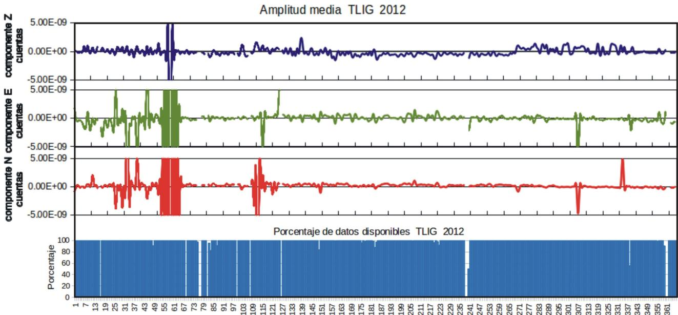
Fig. 4.41. Gráfica de los valores de amplitudes promedio de los registros en continuo de las tres componentes de velocidad de la estación Tlapa y de los porcentajes de disponibilidad de datos en continuo de registros de velocidad. Las valores de las amplitudes promedio están en cuentas. El eje de las abscisas corresponde a los 366 días julianos del año 2012.
