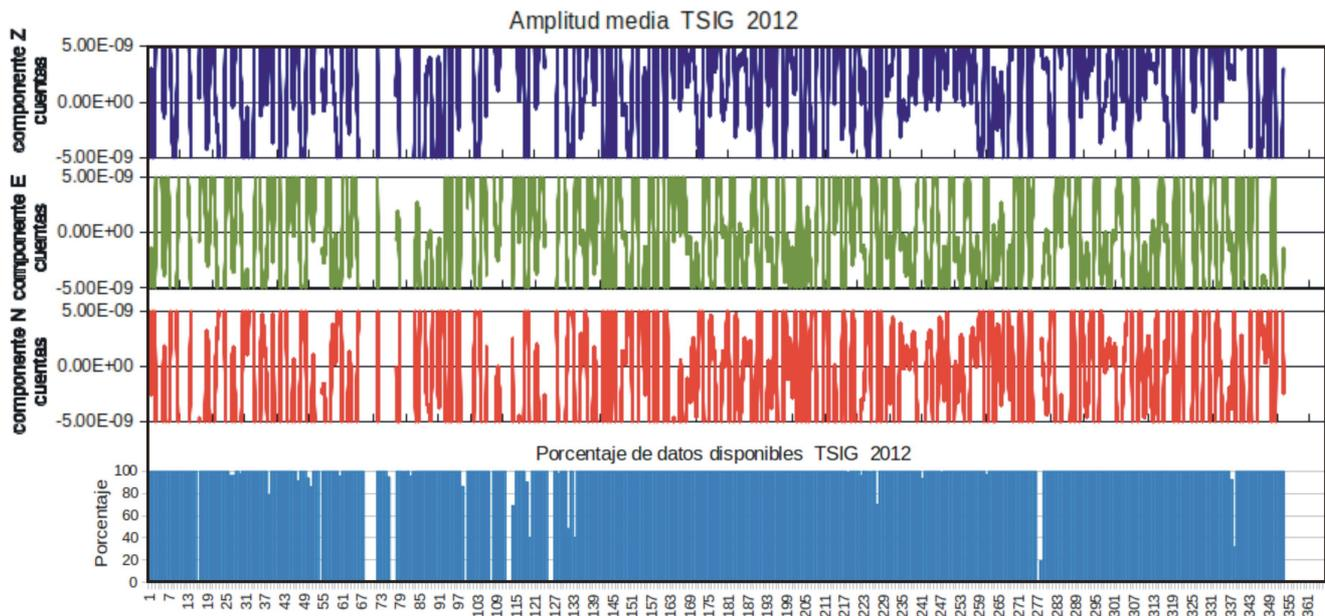
Fig. 4.44. Gráfica de los valores de amplitudes promedio de los registros en continuo de las tres componentes de velocidad de la estación Topolobambo y de los porcentajes de disponibilidad de datos en continuo de registros de velocidad. Las valores de las amplitudes promedio están en cuentas. El eje de las abscisas corresponde a los 366 días julianos del año 2012.
