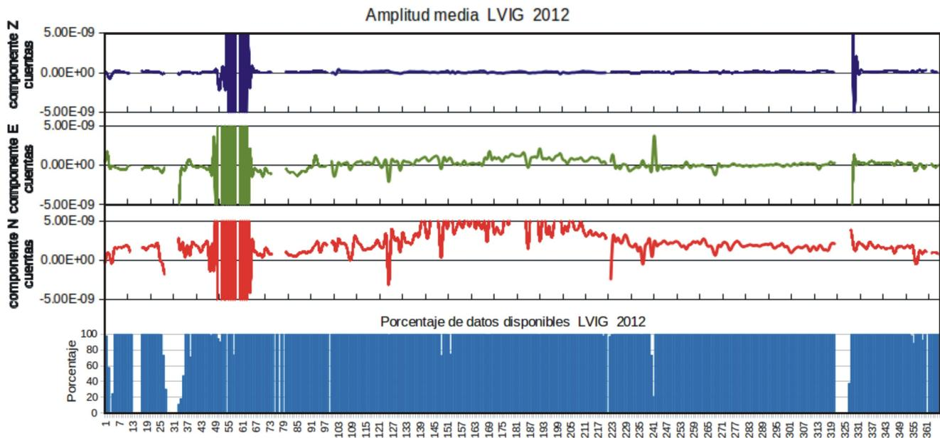
Fig. 4.19. Gráfica de los valores de amplitudes promedio de los registros en continuo de las tres componentes de velocidad de la estación Laguna Verde y de los porcentajes de disponibilidad de datos en continuo de registros de velocidad. Las valores de las amplitudes promedio están en cuentas. El eje de las abscisas corresponde a los 366 días julianos del año 2012.
