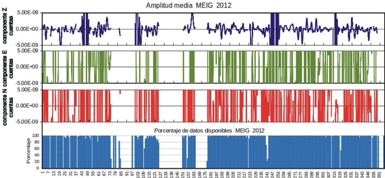
Fig. 4.22. Gráfica de los valores de amplitudes promedio de los registros en continuo de las tres componentes de velocidad de la estación Mezcala y de los porcentajes de disponibilidad de datos en continuo de registros de velocidad. Las valores de las amplitudes promedio están en cuentas. El eje de las abscisas corresponde a los 366 días julianos del año 2012.
