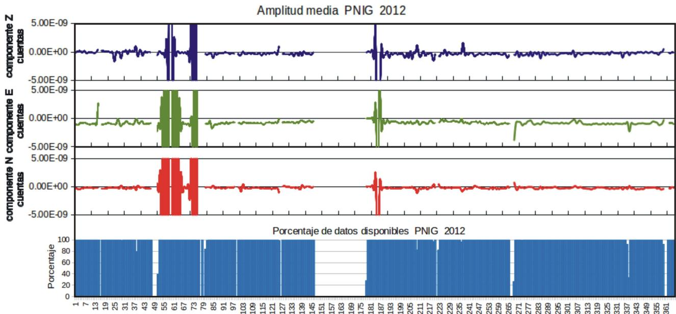
Fig. 4.31. Gráfica de los valores de amplitudes promedio de los registros en continuo de las tres componentes de velocidad de la estación Pinotepa y de los porcentajes de disponibilidad de datos en continuo de registros de velocidad. Las valores de las amplitudes promedio están en cuentas. El eje de las abscisas corresponde a los 366 días julianos del año 2012.
