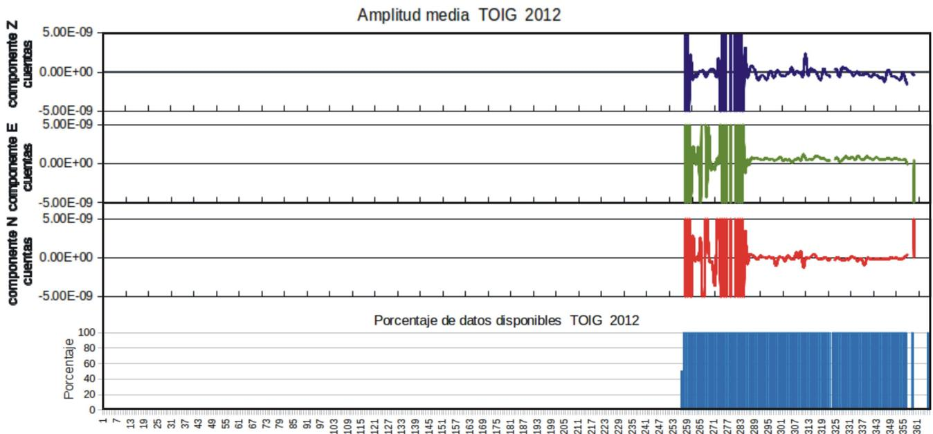
Fig. 4.42. Gráfica de los valores de amplitudes promedio de los registros en continuo de las tres componentes de velocidad de la estación Toxpalán y de los porcentajes de disponibilidad de datos en continuo de registros de velocidad. Los valores de las amplitudes promedio están en cuentas. El eje de las abscisas corresponde a los 366 días julianos del año 2012.
