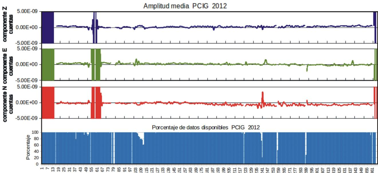
Fig. 4.28. Gráfica de los valores de amplitudes promedio de los registros en continuo de las tres componentes de velocidad de la estación Pijijiapan y de los porcentajes de disponibilidad de datos en continuo de registros de velocidad. Las valores de las amplitudes promedio están en cuentas. El eje de las abscisas corresponde a los 366 días julianos del año 2012.
