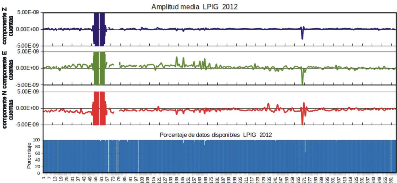
Fig. 4.18. Gráfica de los valores de amplitudes promedio de los registros en continuo de las tres componentes de velocidad de la estación La Paz y de los porcentajes de disponibilidad de datos en continuo de registros de velocidad. Las valores de las amplitudes promedio están en cuentas. El eje de las abscisas corresponde a los 366 días julianos del año 2012.
