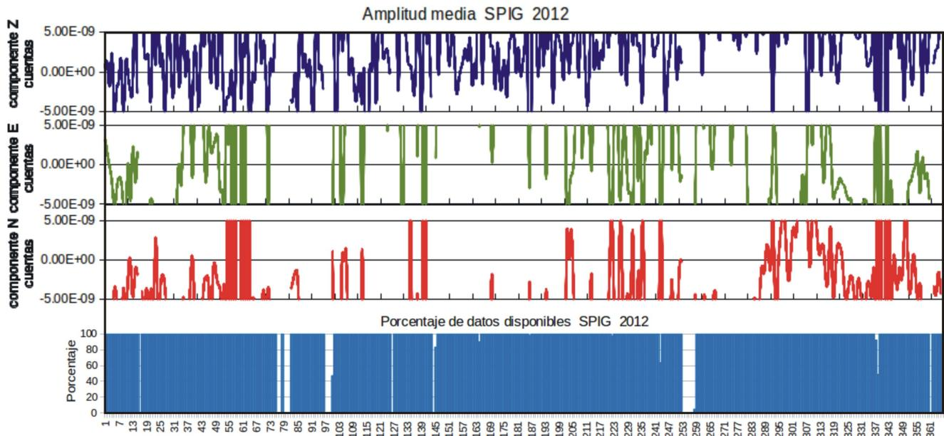
Fig. 4.35. Gráfica de los valores de amplitudes promedio de los registros en continuo de las tres componentes de velocidad de la estación San Pedro Mártir y de los porcentajes de disponibilidad de datos en continuo de registros de velocidad. Las valores de las amplitudes promedio están en cuantías. El eje de las abscisas corresponde a los 366 días julianos del año 2012.
