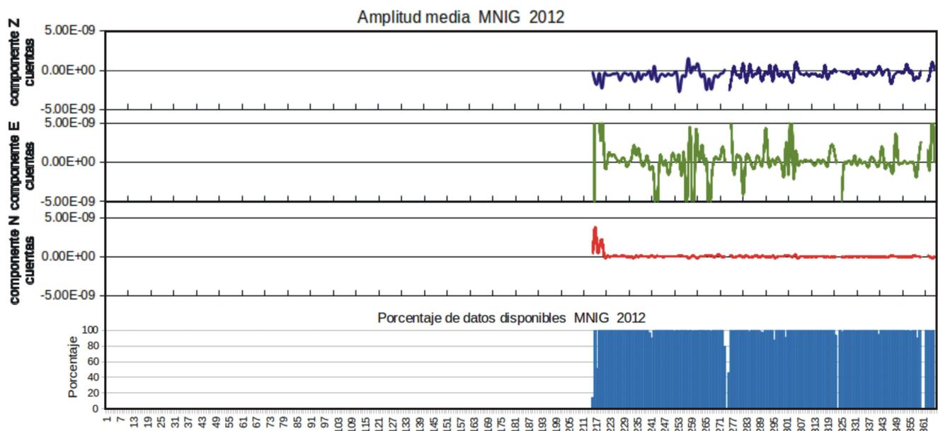
Fig. 4.24. Gráfica de los valores de amplitudes promedio de los registros en continuo de las tres componentes de velocidad de la estación Monterrey y de los porcentajes de disponibilidad de datos en continuo de registros de velocidad. Los valores de las amplitudes promedio están en cuentas. El eje de las abscisas corresponde a los 366 días julianos del año 2012.
