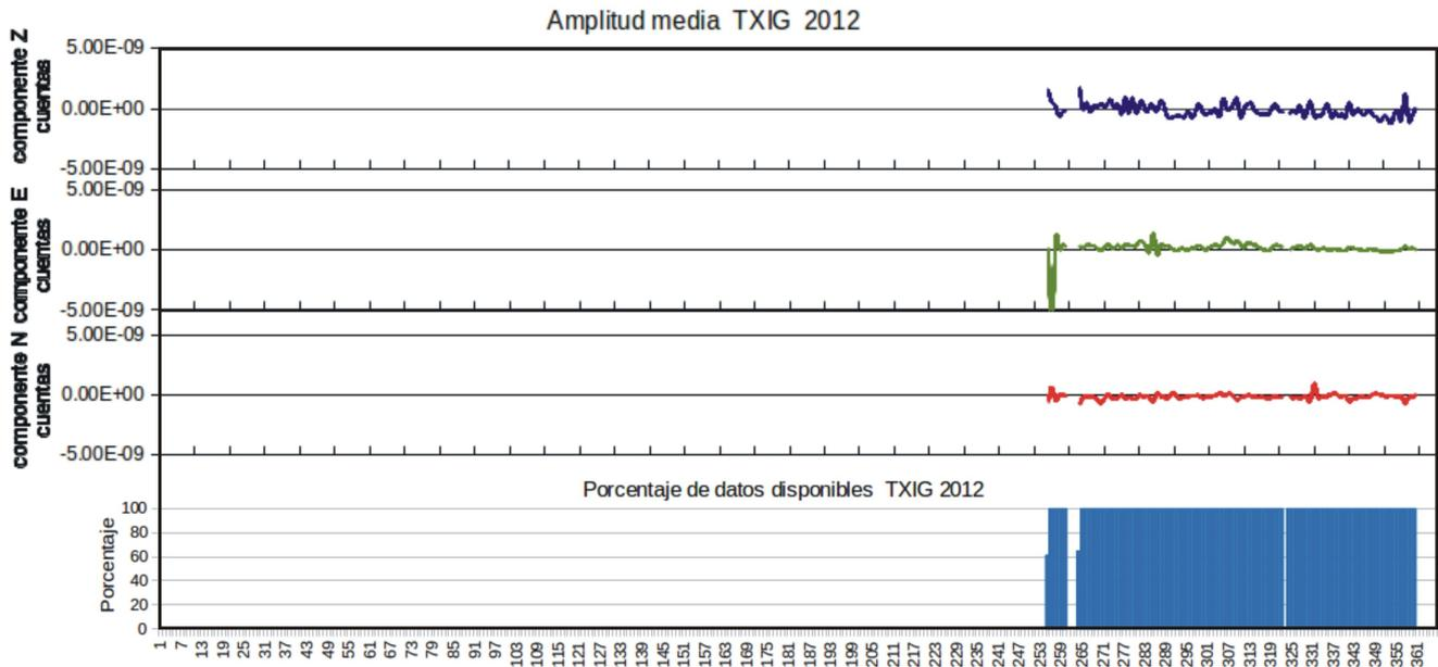
Fig. 4.46. Gráfica de los valores de amplitudes promedio de los registros en continuo de las tres componentes de velocidad de la estación Mazatlán y de los porcentajes de disponibilidad de datos en continuo de registros de velocidad. Las valores de las amplitudes promedio están en cuentas. El eje de las abscisas corresponde a los 366 días julianos del año 2012.
