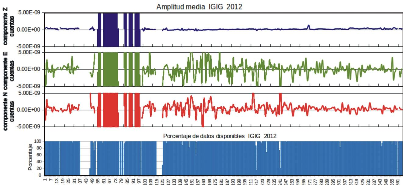
Fig. 4.15. Gráfica de los valores de amplitudes promedio de los registros en continuo de las tres componentes de velocidad de la estación Irapuato y de los porcentajes de disponibilidad de datos en continuo de registros de velocidad. Las valores de las amplitudes promedio están en cuentas. El eje de las abscisas corresponde a los 366 días julianos del año 2012.
