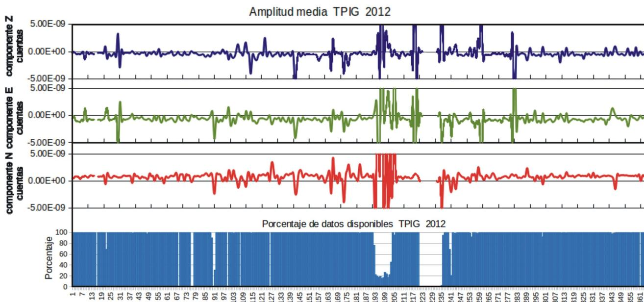
Fig. 4.43. Gráfica de los valores de amplitudes promedio de los registros en continuo de las tres componentes de velocidad de la estación Tehuacán y de los porcentajes de disponibilidad de datos en continuo de registros de velocidad. Las valores de las amplitudes promedio están en cuentas. El eje de las abscisas corresponde a los 366 días julianos del año 2012.
