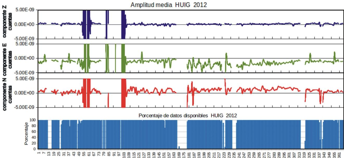
Fig. 4.14. Gráfica de los valores de amplitudes promedio de los registros en continuo de las tres componentes de velocidad de la estación Huatulco y de los porcentajes de disponibilidad de datos en continuo de registros de velocidad. Las valores de las amplitudes promedio están en cuentas. El eje de las abscisas corresponde a los 366 días julianos del año 2012.
