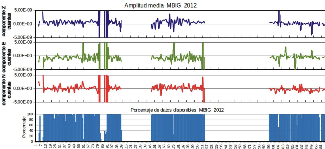
Fig. 4.21. Gráfica de los valores de amplitudes promedio de los registros en continuo de las tres componentes de velocidad de la estación Mexicali y de los porcentajes de disponibilidad de datos en continuo de registros de velocidad. Los valores de las amplitudes promedio están en cuentas. El eje de las abscisas corresponde a los 366 días julianos del año 2012.
