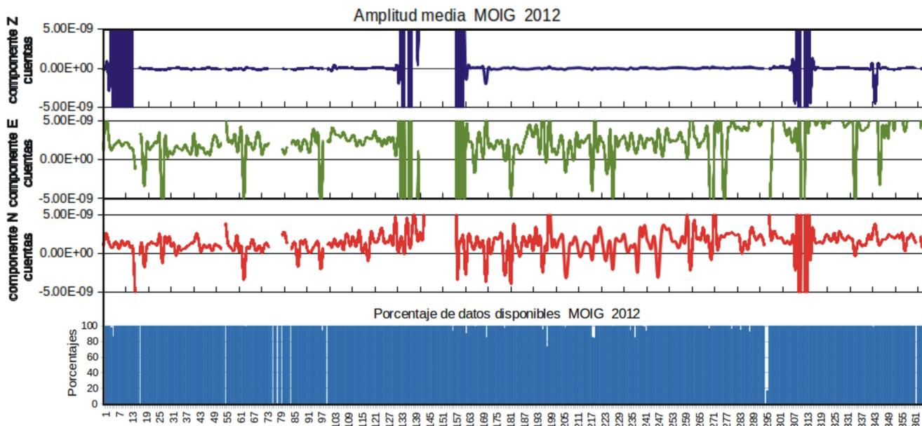
Fig. 4.25. Gráfica de los valores de amplitudes promedio de los registros en continuo de las tres componentes de velocidad de la estación Morelia y de los porcentajes de disponibilidad de datos en continuo de registros de velocidad. Las valores de las amplitudes promedio están en cuentas. El eje de las abscisas corresponde a los 366 días julianos del año 2012.
