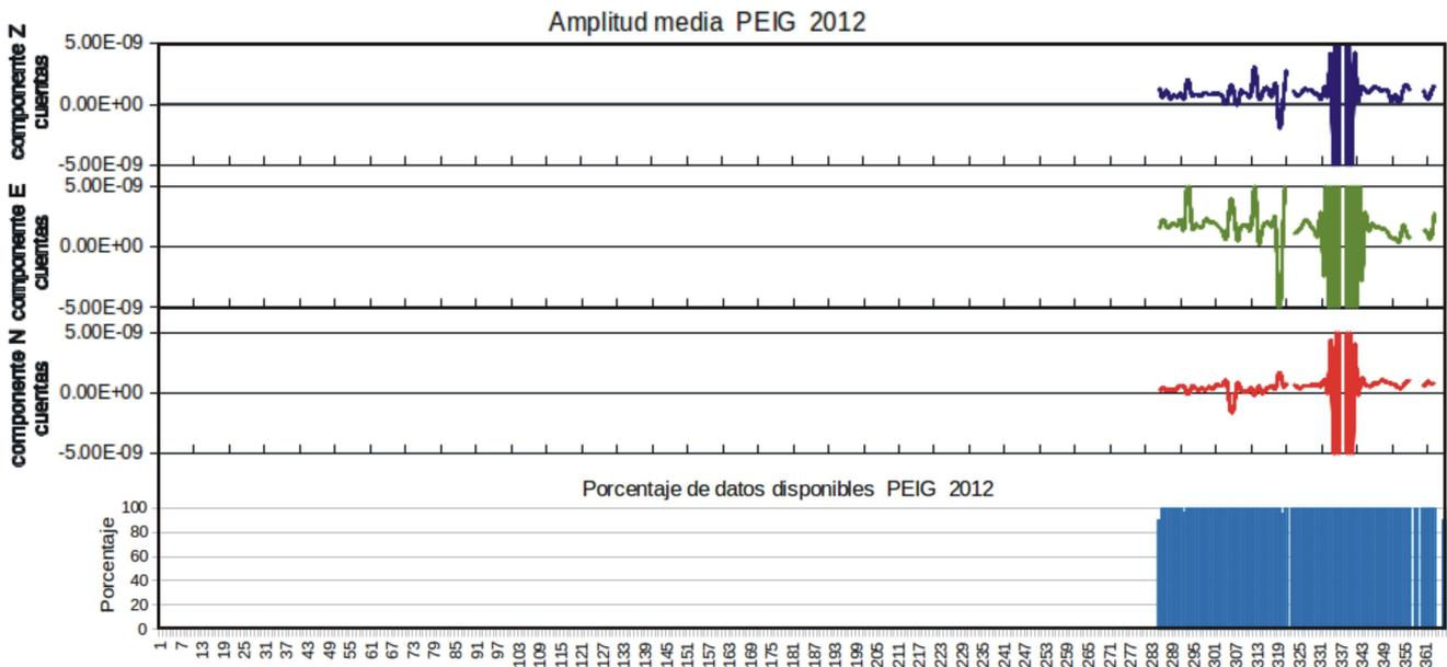
Fig. 4.29. Gráfica de los valores de amplitudes promedio de los registros en continuo de las tres componentes de velocidad de la estación Puerto Escondido y de los porcentajes de disponibilidad de datos en continuo de registros de velocidad. Los valores de las amplitudes promedio están en cuentas. El eje de las abscisas corresponde a los 366 días julianos del año 2012.
