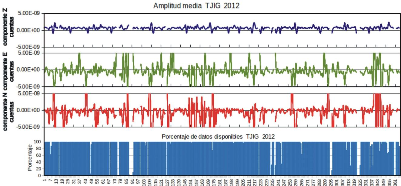
Fig. 4.40. Gráfica de los valores de amplitudes promedio de los registros en continuo de las tres componentes de velocidad de la estación Tijuana y de los porcentajes de disponibilidad de datos en continuo de registros de velocidad. Las valores de las amplitudes promedio están en cuentas. El eje de las abscisas corresponde a los 366 días julianos del año 2012.
