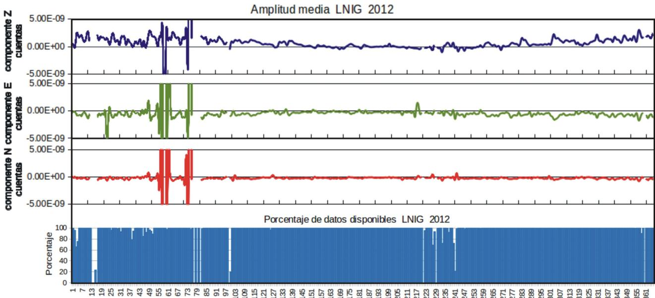
Fig. 4.17. Gráfica de los valores de amplitudes promedio de los registros en continuo de las tres componentes de velocidad de la estación Linares y de los porcentajes de disponibilidad de datos en continuo de registros de velocidad. Las valores de las amplitudes promedio están en cuentas. El eje de las abscisas corresponde a los 366 días julianos del año 2012.
