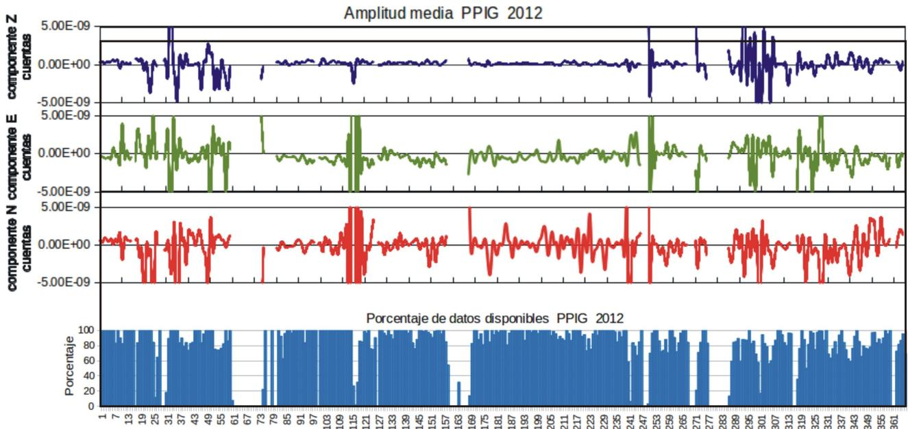
Fig. 4.32. Gráfica de los valores de amplitudes promedio de los registros en continuo de las tres componentes de velocidad de la estación Popocatepetl y de los porcentajes de disponibilidad de datos en continuo de registros de velocidad. Los valores de las amplitudes promedio están en cuentas. El eje de las abscisas corresponde a los 366 días julianos del año 2012.
