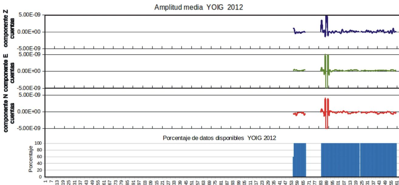
Fig. 4.49. Gráfica de los valores de amplitudes promedio de los registros en continuo de las tres componentes de velocidad de la estación Yosondúa y de los porcentajes de disponibilidad de datos en continuo de registros de velocidad. Los valores de las amplitudes promedio están en cuentas. El eje de las abscisas corresponde a los 366 días julianos del año 2012.
