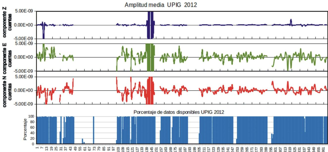
Fig. 4.47. Gráfica de los valores de amplitudes promedio de los registros en continuo de las tres componentes de velocidad de la estación Panamá y de los porcentajes de disponibilidad de datos en continuo de registros de velocidad. Las valores de las amplitudes promedio están en cuentas. El eje de las abscisas corresponde a los 366 días julianos del año 2012.
