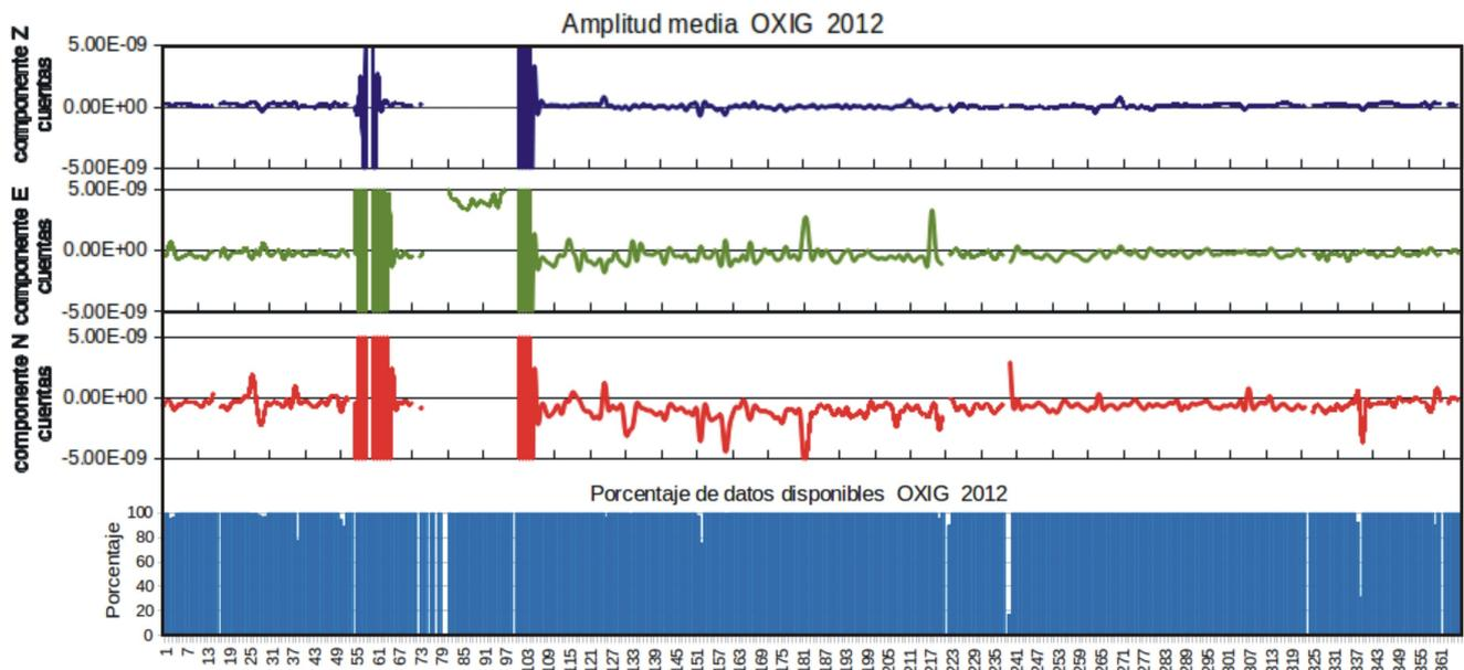
Fig. 4.27. Gráfica de los valores de amplitudes promedio de los registros en continuo de las tres componentes de velocidad de la estación Oaxaca y de los porcentajes de disponibilidad de datos en continuo de registros de velocidad. Las valores de las amplitudes promedio están en cuentas. El eje de las abscisas corresponde a los 366 días julianos del año 2012.
