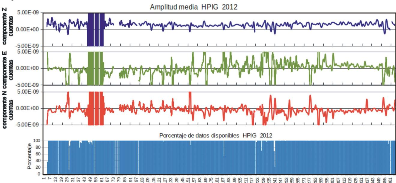
Fig. 4.12. Gráfica de los valores de amplitudes promedio de los registros en continuo de las tres componentes de velocidad de la estación Hidalgo del Parral y de los porcentajes de disponibilidad de datos en continuo de registros de velocidad. Los valores de las amplitudes promedio están en cuentas. El eje de las abscisas corresponde a los 366 días julianos del año 2012.
