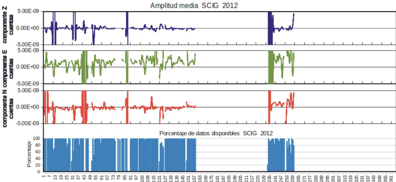
Fig. 4.34. Gráfica de los valores de amplitudes promedio de los registros en continuo de las tres componentes de velocidad de la estación Sabancuy y de los porcentajes de disponibilidad de datos en continuo de registros de velocidad. Las valores de las amplitudes promedio están en cuentas. El eje de las abscisas corresponde a los 366 días julianos del año 2012.
