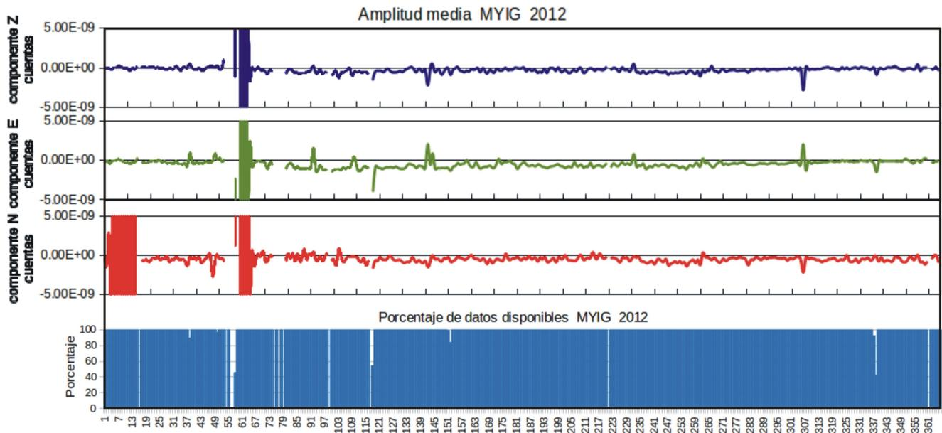
Fig. 4.26. Gráfica de los valores de amplitudes promedio de los registros en continuo de las tres componentes de velocidad de la estación Mérida y de los porcentajes de disponibilidad de datos en continuo de registros de velocidad. Las valores de las amplitudes promedio están en cuentas. El eje de las abscisas corresponde a los 366 días julianos del año 2012.
