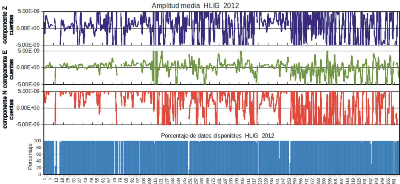
Fig. 4.11. Gráfica de los valores de amplitudes promedio de los registros en continuo de las tres componentes de velocidad de la estación Huajuapán y de los porcentajes de disponibilidad de datos en continuo de registros de velocidad. Los valores de las amplitudes promedio están en cuentas. El eje de las abscisas corresponde a los 366 días julianos del año 2012.
