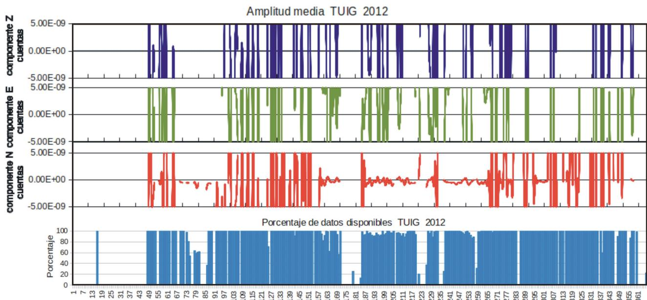
Fig. 4.45. Gráfica de los valores de amplitudes promedio de los registros en continuo de las tres componentes de velocidad de la estación Tuzandepetl y de los porcentajes de disponibilidad de datos en continuo de registros de velocidad. Las valores de las amplitudes promedio están en cuentas. El eje de las abscisas corresponde a los 366 días julianos del año 2012.
