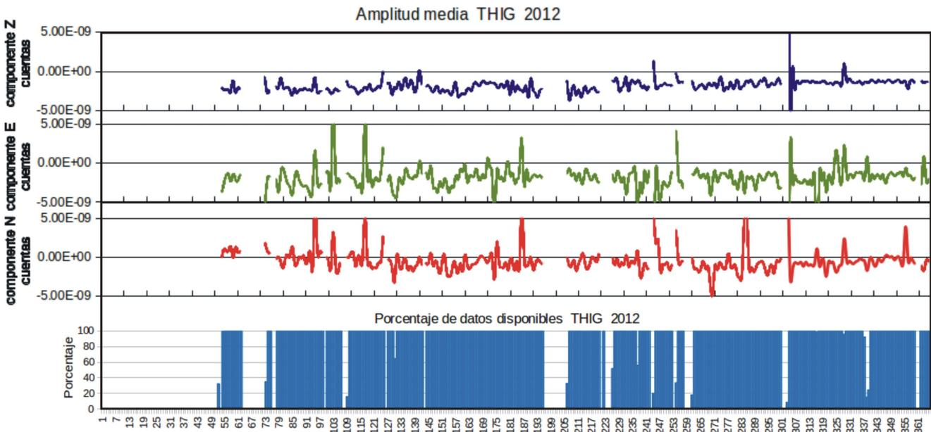
Fig. 4.39. Gráfica de los valores de amplitudes promedio de los registros en continuo de las tres componentes de velocidad de la estación Tapachula y de los porcentajes de disponibilidad de datos en continuo de registros de velocidad. Las valores de las amplitudes promedio están en cuentas. El eje de las abscisas corresponde a los 366 días julianos del año 2012.
