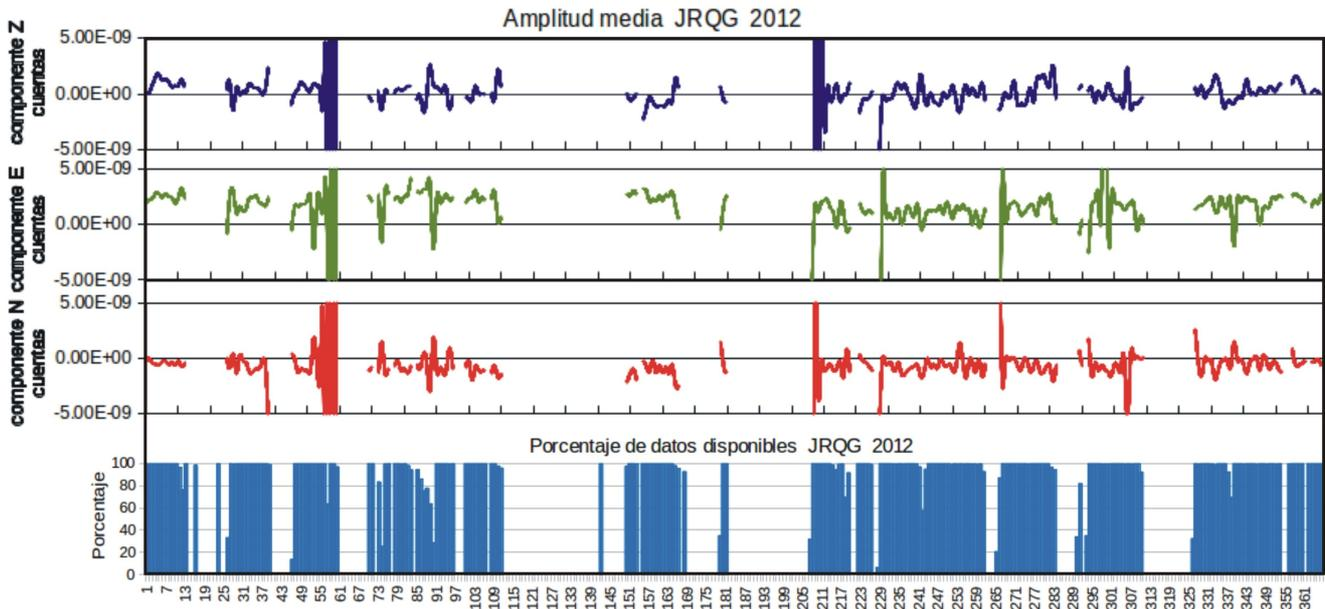
Fig. 4.16. Gráfica de los valores de amplitudes promedio de los registros en continuo de las tres componentes de velocidad de la estación Juriquilla y de los porcentajes de disponibilidad de datos en continuo de registros de velocidad. Los valores de las amplitudes promedio están en cuentas. El eje de las abscisas corresponde a los 366 días julianos del año 2012.
