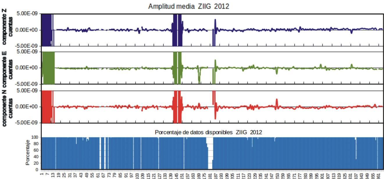
Fig. 4.51. Gráfica de los valores de amplitudes promedio de los registros en continuo de las tres componentes de velocidad de la estación Zihuatanejo y de los porcentajes de disponibilidad de datos en continuo de registros de velocidad. Los valores de las amplitudes promedio están en cuentas. El eje de las abscisas corresponde a los 366 días julianos del año 2012.
