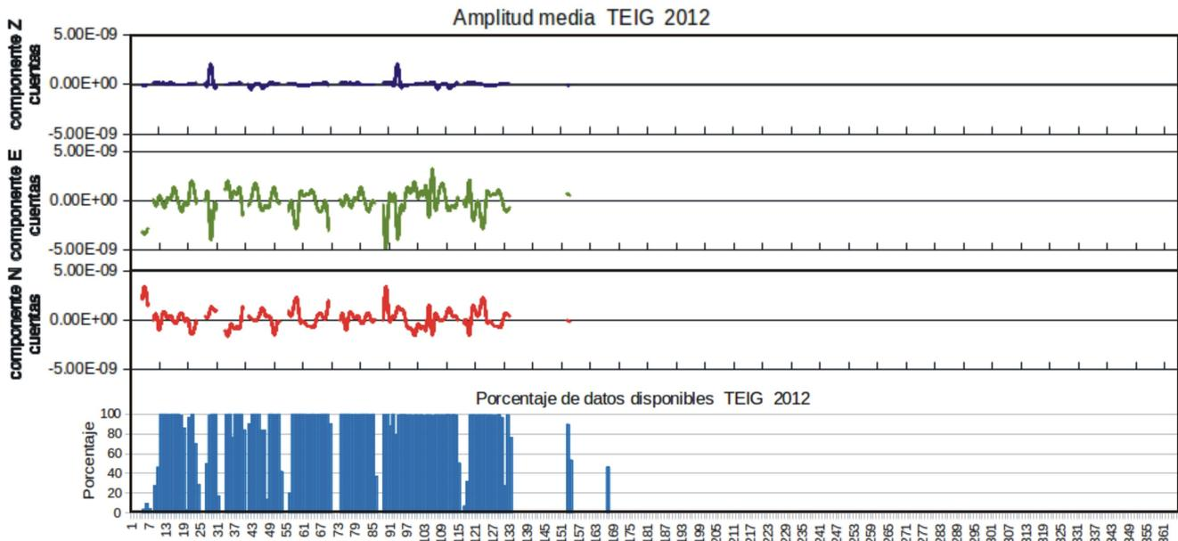
Fig. 4.37. Gráfica de los valores de amplitudes promedio de los registros en continuo de las tres componentes de velocidad de la estación Tepich y de los porcentajes de disponibilidad de datos en continuo de registros de velocidad. Las valores de las amplitudes promedio están en cuentas. El eje de las abscisas corresponde a los 366 días julianos del año 2012.
