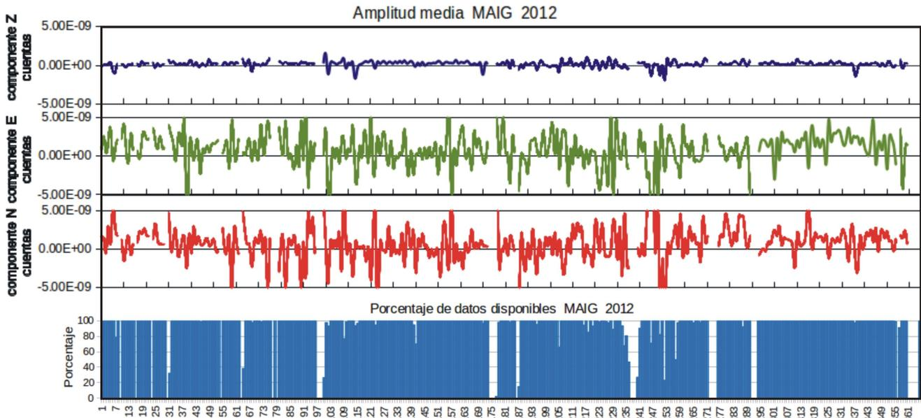
Fig. 4.20. Gráfica de los valores de amplitudes promedio de los registros en continuo de las tres componentes de velocidad de la estación Mazatlán y de los porcentajes de disponibilidad de datos en continuo de registros de velocidad. Los valores de las amplitudes promedio están en cuentas. El eje de las abscisas corresponde a los 366 días julianos del año 2012.
