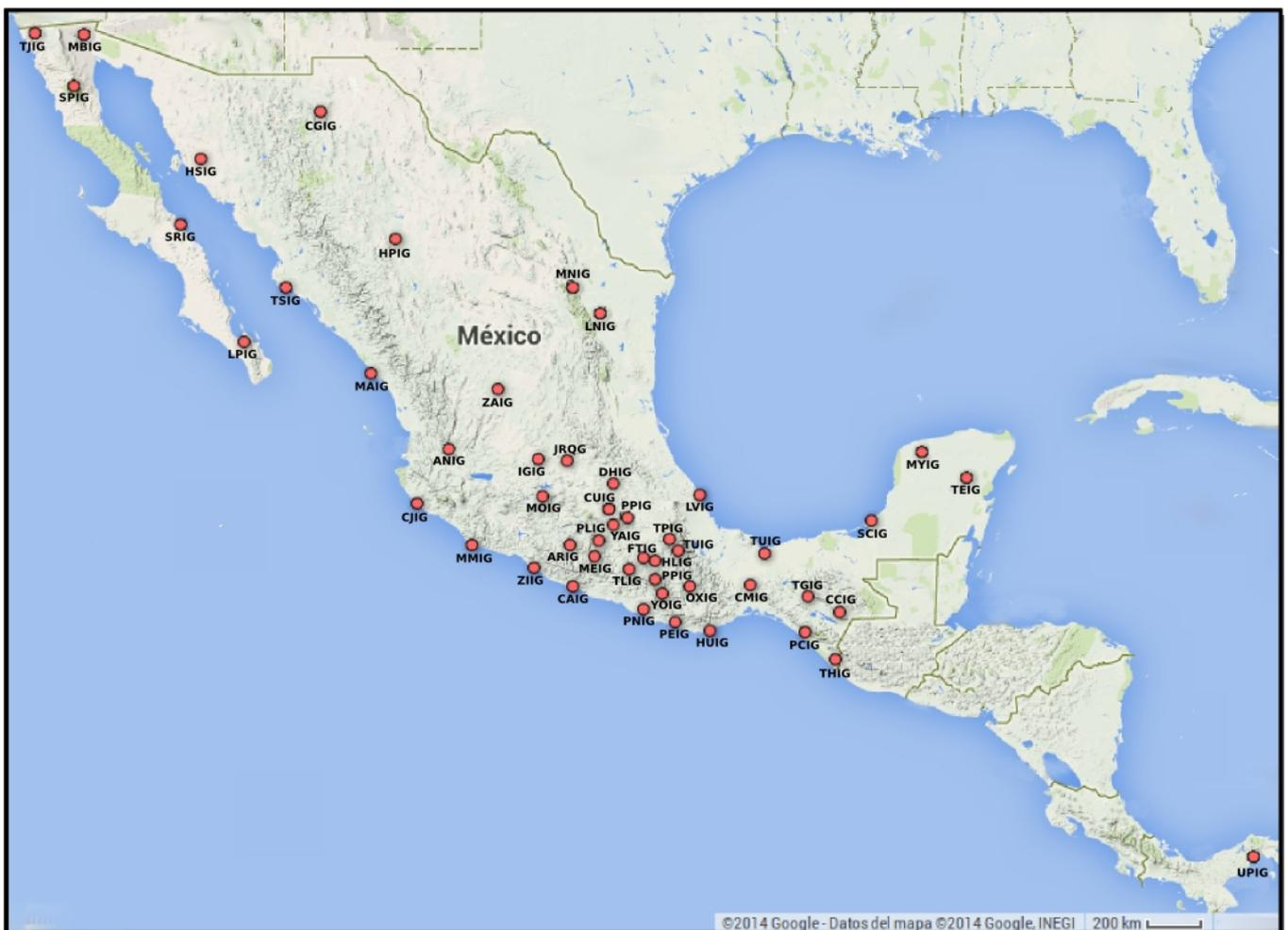
Fig. 2.1. Distribución de las estaciones de banda ancha del Servicio Sismológico Nacional.
