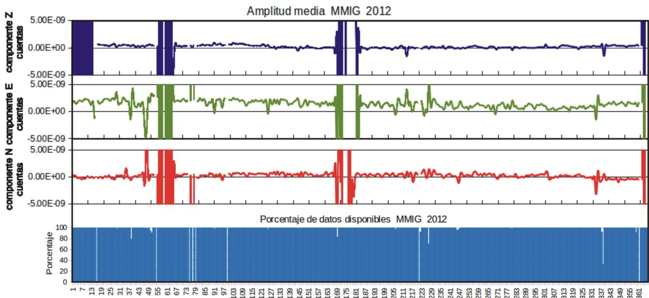
Fig. 4.23. Gráfica de los valores de amplitudes promedio de los registros en continuo de las tres componentes de velocidad de la estación Maruata y de los porcentajes de disponibilidad de datos en continuo de registros de velocidad. Los valores de las amplitudes promedio están en cuentas. El eje de las abscisas corresponde a los 366 días julianos del año 2012.
