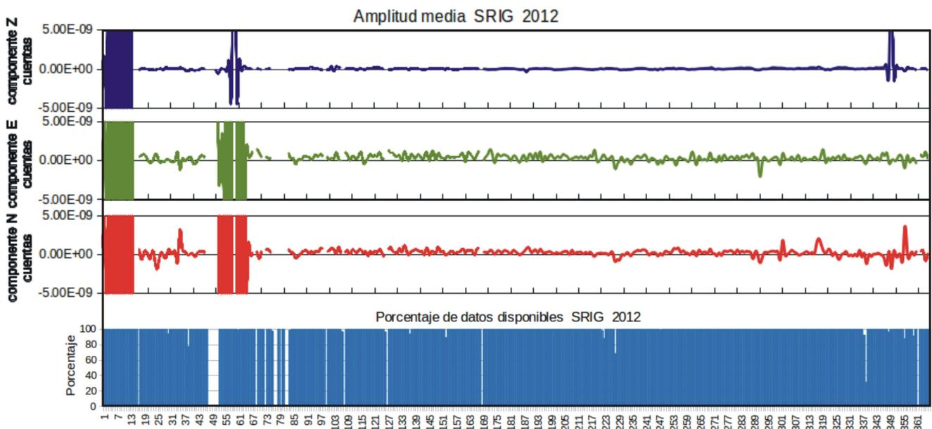
Fig. 4.36. Gráfica de los valores de amplitudes promedio de los registros en continuo de las tres componentes de velocidad de la estación Santa Rosalía y de los porcentajes de disponibilidad de datos en continuo de registros de velocidad. Las valores de las amplitudes promedio están en cuantías. El eje de las abscisas corresponde a los 366 días julianos del año 2012.
