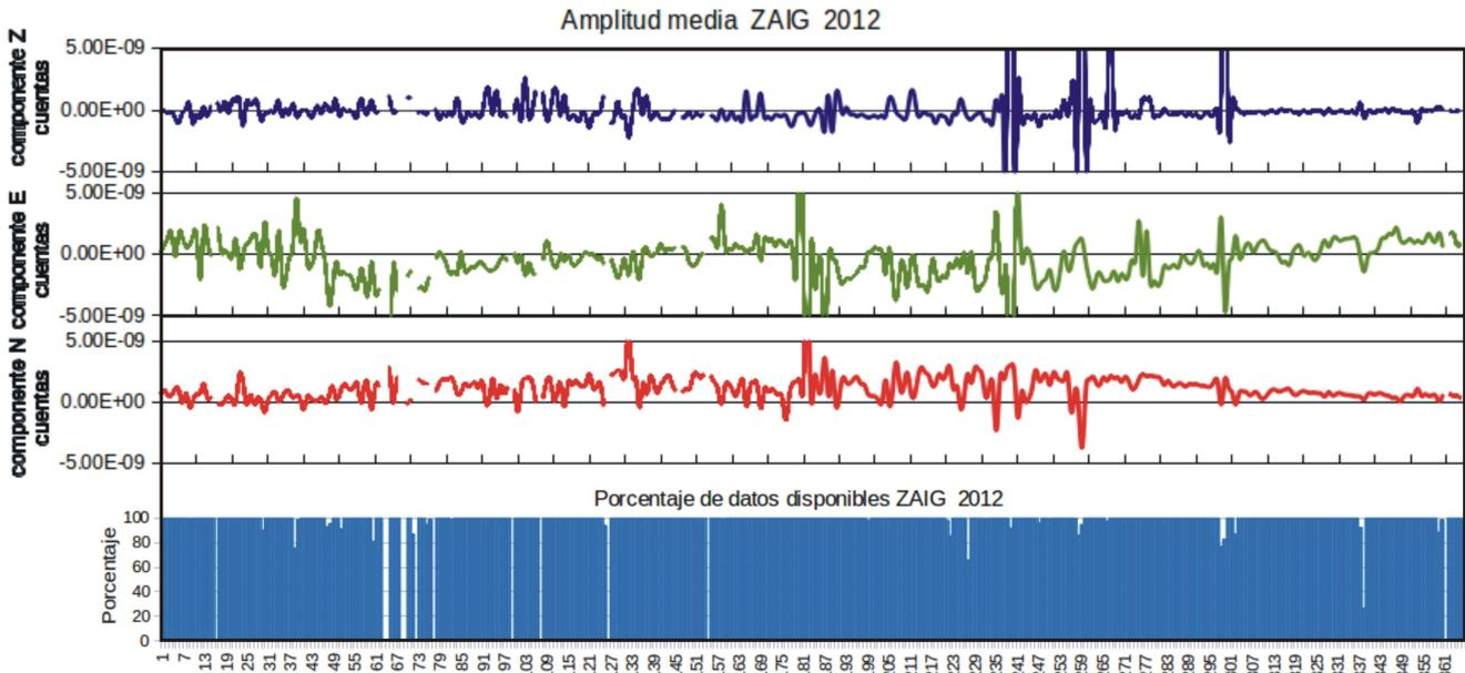
Fig. 4.50. Gráfica de los valores de amplitudes promedio de los registros en continuo de las tres componentes de velocidad de la estación Zacatecas y de los porcentajes de disponibilidad de datos en continuo de registros de velocidad. Los valores de las amplitudes promedio están en cuentas. El eje de las abscisas corresponde a los 366 días julianos del año 2012.
