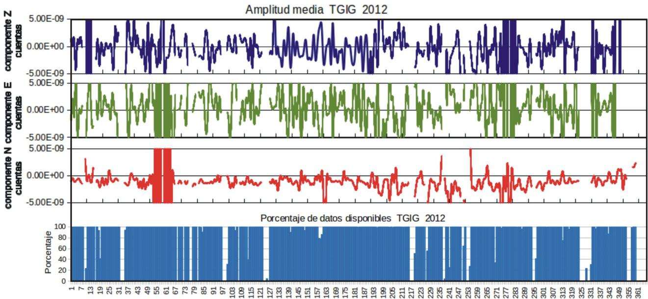
Fig. 4.38. Gráfica de los valores de amplitudes promedio de los registros en continuo de las tres componentes de velocidad de la estación Tuxtla Gutiérrez y de los porcentajes de disponibilidad de datos en continuo de registros de velocidad. Las valores de las amplitudes promedio están en cuentas. El eje de las abscisas corresponde a los 366 días julianos del año 2012.
