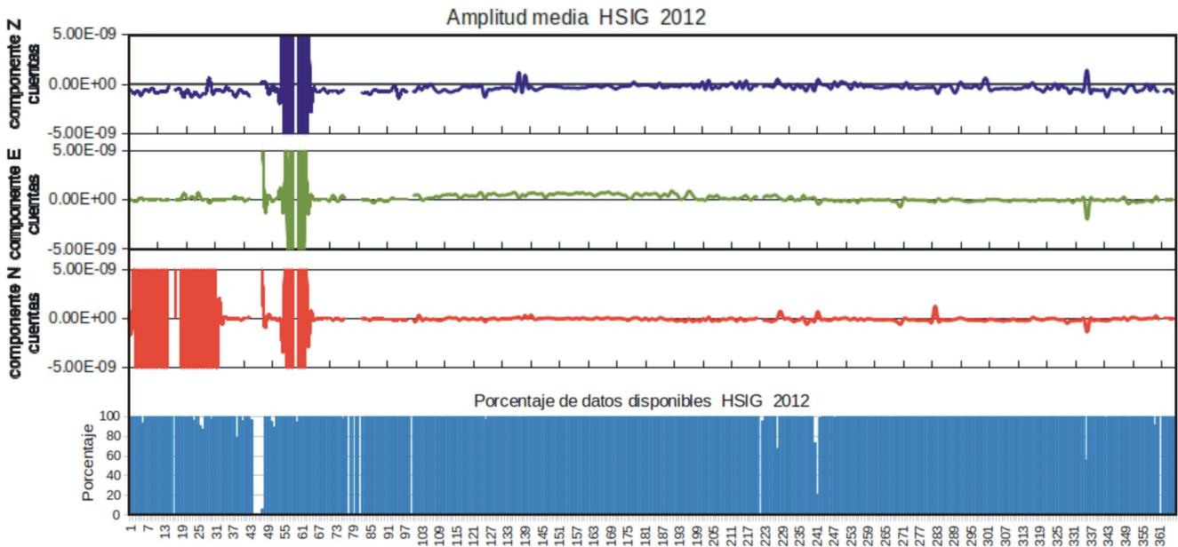
Fig. 4.13. Gráfica de los valores de amplitudes promedio de los registros en continuo de las tres componentes de velocidad de la estación Hermosillo y de los porcentajes de disponibilidad de datos en continuo de registros de velocidad. Las valores de las amplitudes promedio están en cuentas. El eje de las abscisas corresponde a los 366 días julianos del año 2012.
