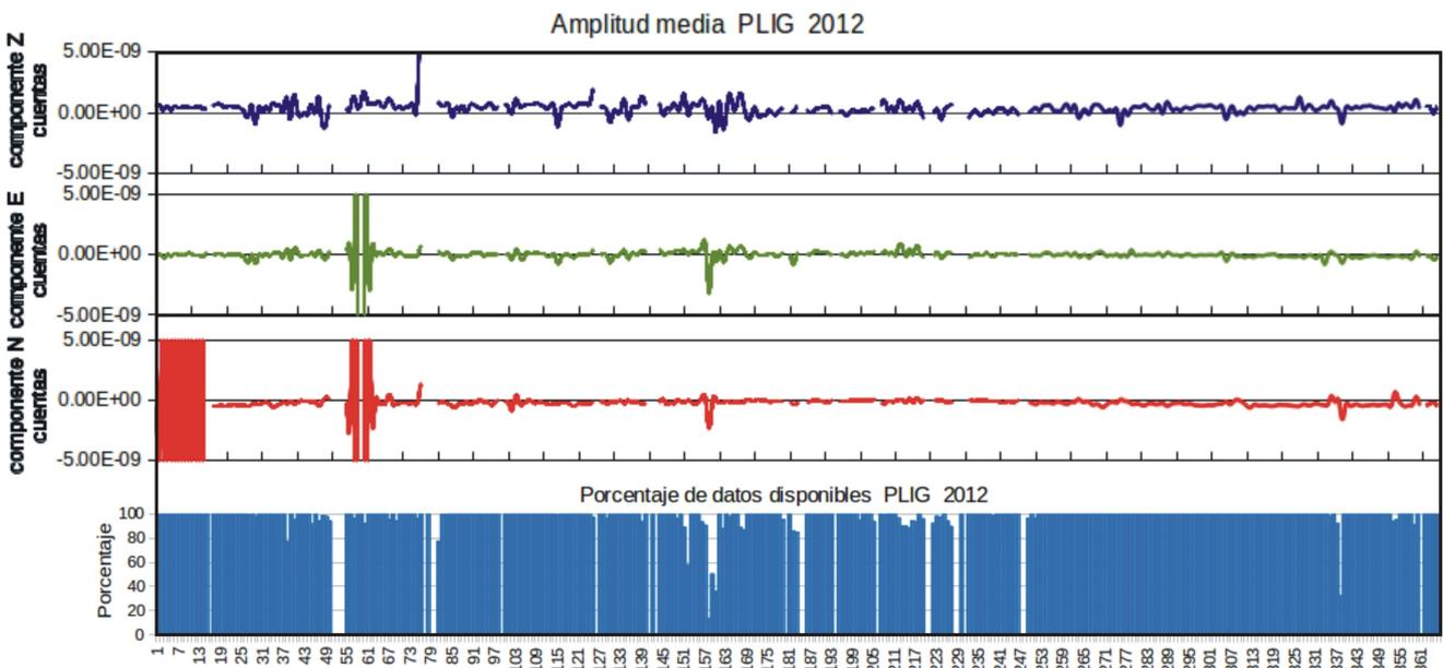
Fig. 4.30. Gráfica de los valores de amplitudes promedio de los registros en continuo de las tres componentes de velocidad de la estación Platanillo y de los porcentajes de disponibilidad de datos en continuo de registros de velocidad. Los valores de las amplitudes promedio están en cuentas. El eje de las abscisas corresponde a los 366 días julianos del año 2012.
