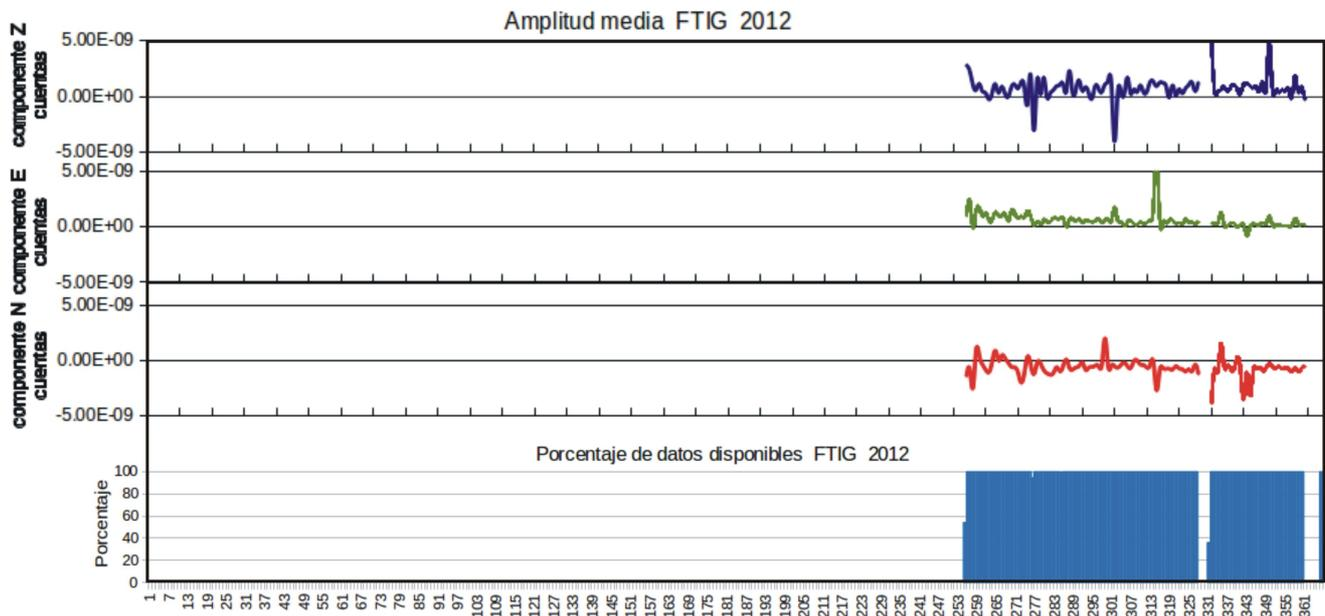
Fig. 4.10. Gráfica de los valores de amplitudes promedio de los registros en continuo de las tres componentes de velocidad de la estación Fresnillo de Trujano y de los porcentajes de disponibilidad de datos en continuo de registros de velocidad. Las valores de las amplitudes promedio están en cuentas. El eje de las abscisas corresponde a los 366 días julianos del año 2012.
