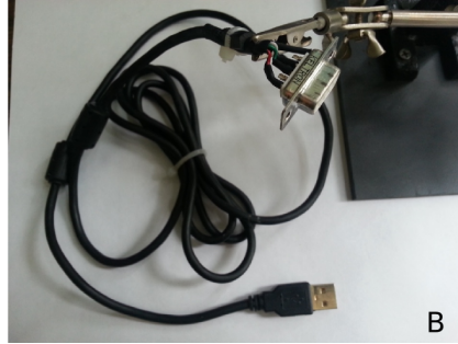
Figura A.5: Fotografías del cable de comunicación del TB a la PC. A) Proceso de elaboración. Se soldan las terminales procedentes del conector USB tipo A a los pines del conector DB9. B) Fotografía del cable terminado.
