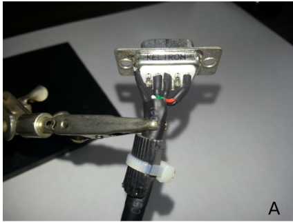
Figura A.5: Fotografías del cable de comunicación del TB a la PC. A) Proceso de elaboración. Se soldan las terminales procedentes del conector USB tipo A a los pines del conector DB9. B) Fotografía del cable terminado.
