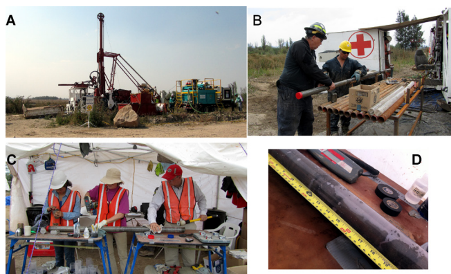
Figura 5 A) Torre de perforación, tuberías y separador de lodos. B) Extracción del tubo de plástico de la herramienta HQ. C) y D) Cada tubo de plástico fue limpiado, etiquetado y posteriormente pesado.
