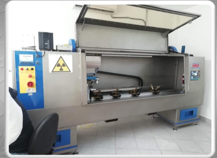
Escáner de FRX "Maya", ubicado en el Laboratorio de Paleoceanografía y Paleoclimas, Instituto de Geofísica, UNAM.
