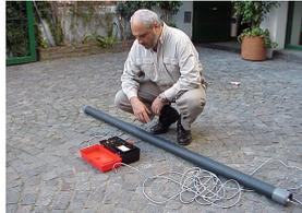
Figura 2: Sensor magnético encapsulado en un tubo de PVC, y la caja que contiene el amplificador y el indicador de aguja.
