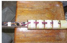
Figura 1: Bobina con 5 carretes de 20000 vueltas cada una insertados sobre 2 rieles de acero de 2m de longitud y una plaqueta que contiene el preamplificador.
