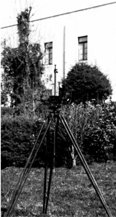
**Figura 6.** Magnetómetro unifilar para la medición de la Intensidad Horizontal del Campo Magnético Terrestre con trípode para prospección de campo (acervo fotográfico del Observatorio Magnético de Teoloyucan)
