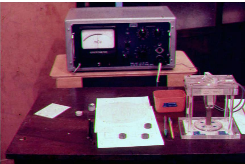
Figura 6. Magnetômetro Fluxgate do Instituto de Física da USP
