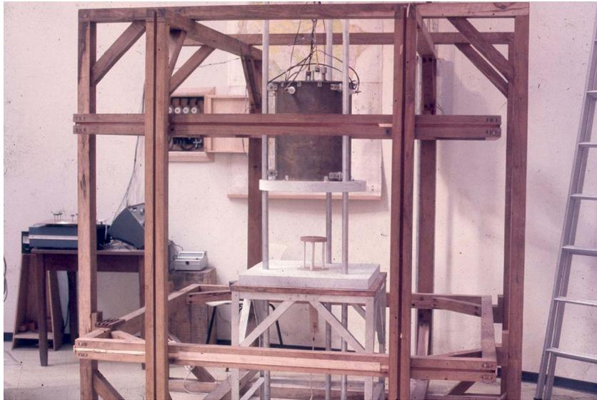
Figura 9. Demagnetizador Térmico de IAG Água Funda
