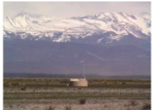
Uno de los 1600 detectores de chubascos atmosféricos que integrarán el proyecto Auger, en Argentina.
