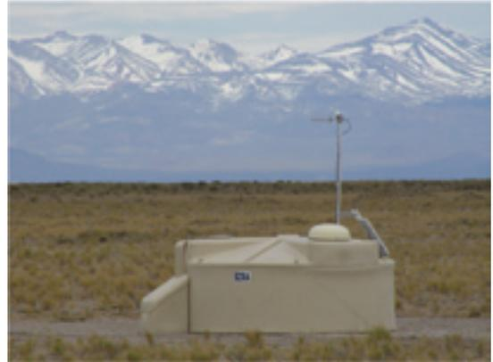
*Uno de los tanques de polietileno de los 1600 que componen el detector de superficie del Observatorio Pierre Auger*
