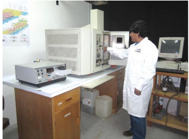
El M. en C. Faustino Juárez en la preparación del espectrómetro de emisión acoplado inductivamente (ICP-OES)
