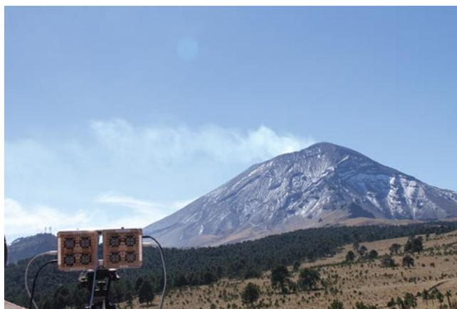
Medición de la emisión de  $\text{SO}_2$  del volcán Popocatepetl, utilizando una cámara UV
