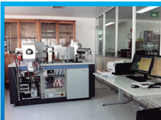
Espectrómetro de masa con fuente sólida TIMS, modelo Triton-Plus (Thermo Scientific) equipado con 9 colectores Faraday y una plataforma independiente con cinco multi-contadores de iones para la medición de edades de U-Pb en circones individuales
