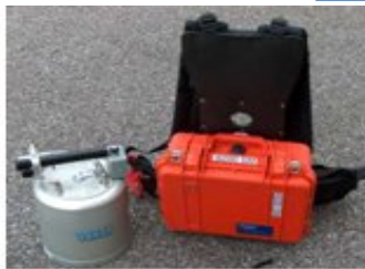
Cámara de acumulación de gases
