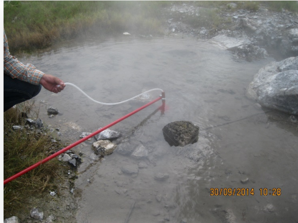
Colecta de gases burbujeante
