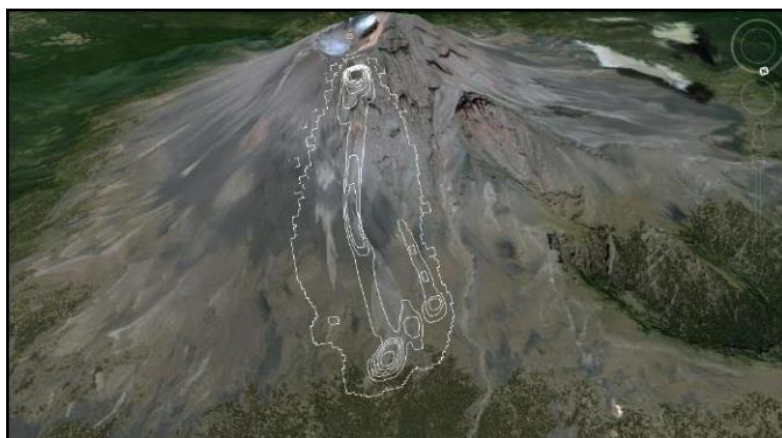
Figura 107. Curvas de profundidad del flujo piroclásticos que se obtuvieron de las simulaciones para la calibración (líneas en blanco) superpuestas a una imagen satelital (Google Earth), donde todavía se aprecia la distribución de los frentes principales de los flujos piroclásticos de 2001.
