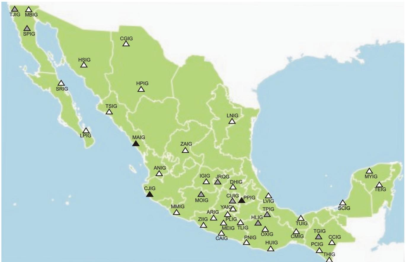
Fig. 2.1. Distribución de las estaciones de banda ancha del Servicio Sismológico Nacional. Los triángulos de color negro indican las estaciones que transmiten los datos vía radio módem, los triángulos de color gris son estaciones que transmiten los datos a través de Internet y en color blanco las estaciones que transmiten vía satélite.
