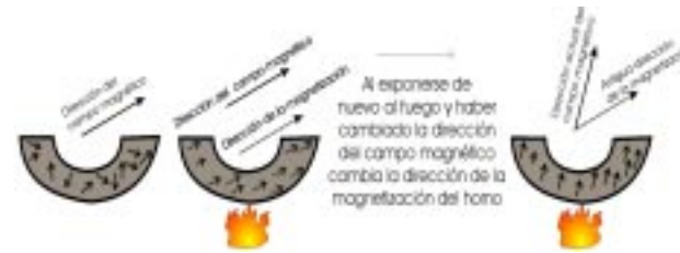
Fig. 5.- Esquema que ilustra la adquisición de magnetización de un material cerámico al calentarse.
