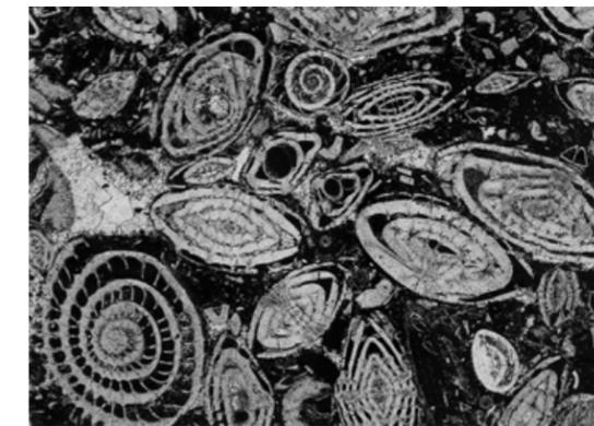
Vista microscópica de una roca sedimentaria que contiene fósiles foraminíferos numulíticos.
