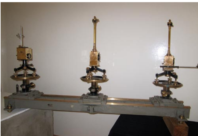
Variógrafo para medir componentes magnéticas. Operó en Teoloyucan entre 1954 y 2010. Actualmente está en exhibición en el Museo de Geofísica
