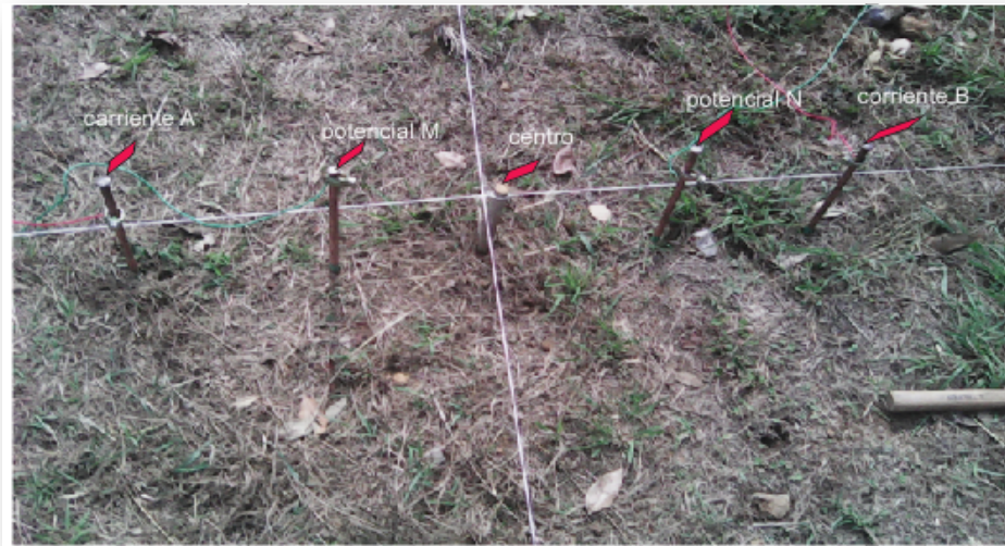
Figura 2. Dispositivo eléctrico tipo Schlumberger.
