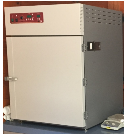
Horno Eléctrico Shel Lab
