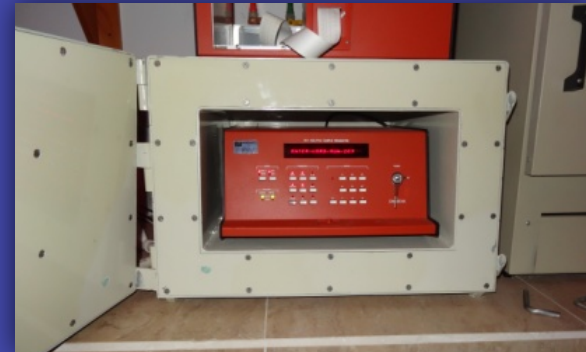
Irradiador Daybreak 801 con fuente beta de ^{90}\text{Sr} y fuente alfa de ^{244}\text{Cm} .
