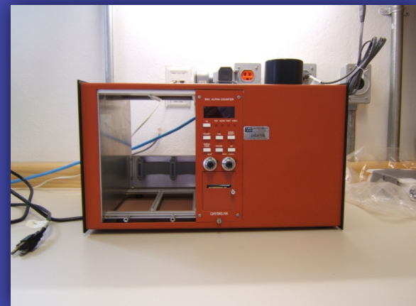
Dos contadores de partículas alfa Daybreak 583 para determinar la concentración de ^{238}\text{U} y ^{232}\text{Th}
