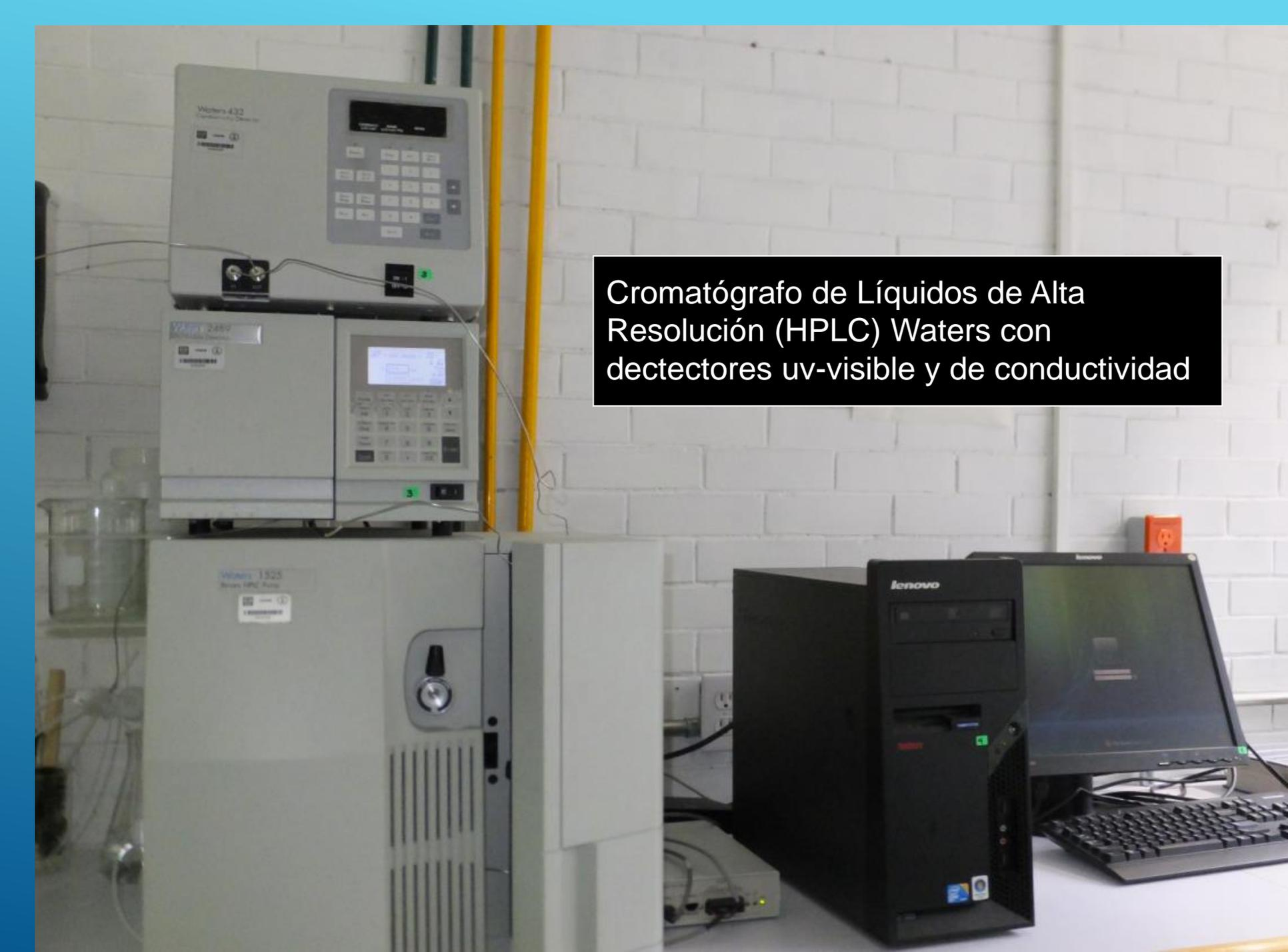
Cromatógrafo de Líquidos de Alta Resolución (HPLC) Waters con detectores uv-visible y de conductividad
